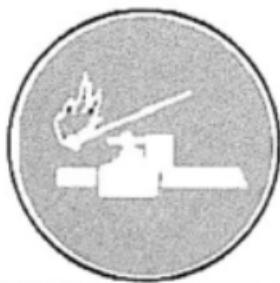
必须先点火后开气 | 必须先点火后开气 | 为防止燃气装置等设备，因点火程序颠倒引发事故而设计。<br>适用于燃气装置      |
