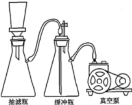
图4 抽滤装置
