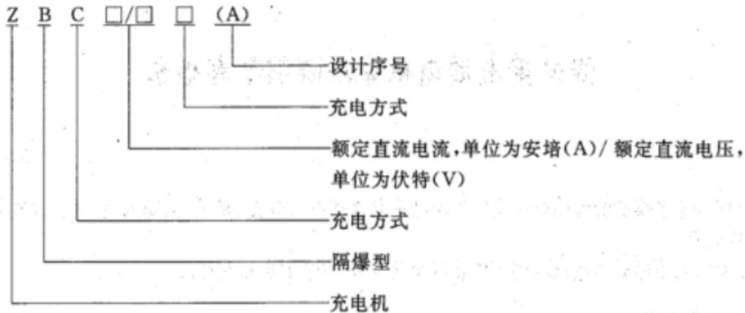
充电方式:快速充电代号用“K”,无代号表示常规充电。
