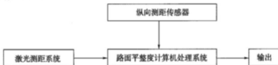
图1 激光平整度仪工作流程图
