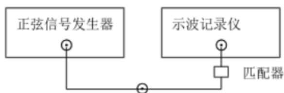
图 12 示波记录仪校准连线图
