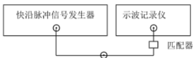
图 3 瞬态特性校准连线图
