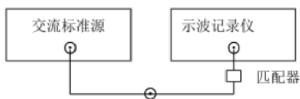
图 10 示波记录仪直流增益校准连线图
