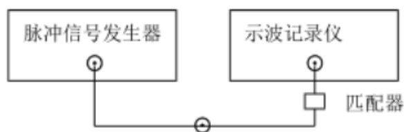
图 7 示波记录仪时间测量校准连线图
