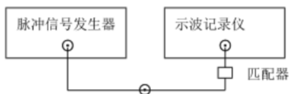
图 9 示波记录仪直流增益校准连线图
