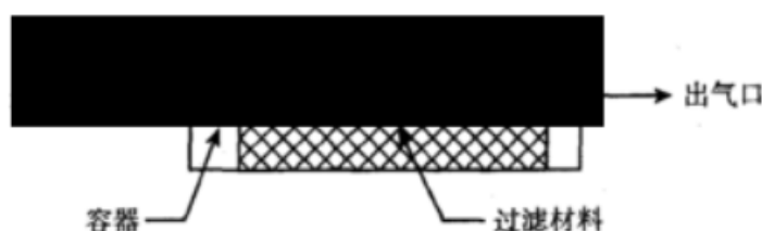
图 D.1 沙尘采样器示意图
