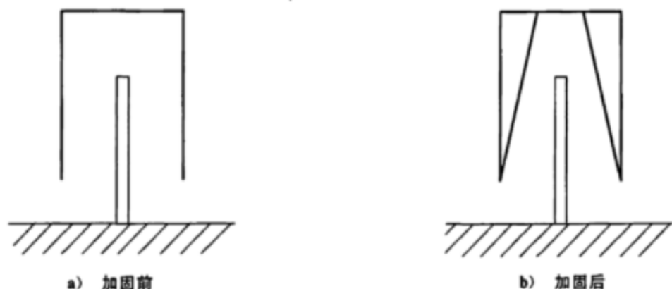
图 16 中心吊式主框架加固示意图
