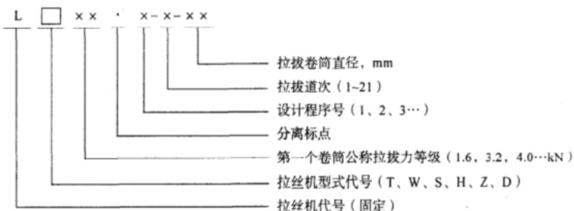
混合式组合的拉丝机, 按组合次序排列, 中间用“+”号连接。
