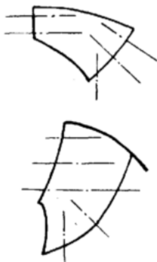
图3 叶片进出水边型线检查部位
