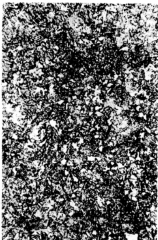
第 6 级 (较多量的块状及条状游离铁素体)
