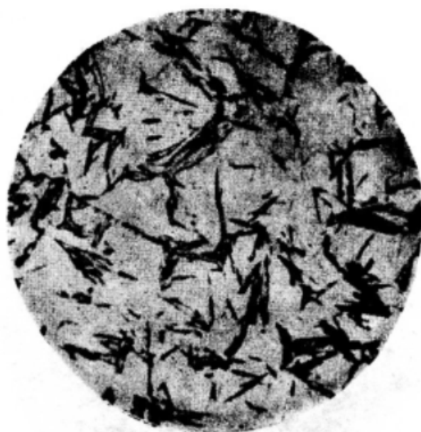
第 7 级 (粗针马氏体, 针的长度 12\sim 16\text{ mm} )
