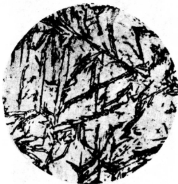
第 9 级 (粗针马氏体, 针的长度 >25 \sim 50 \mu\text{m} )
