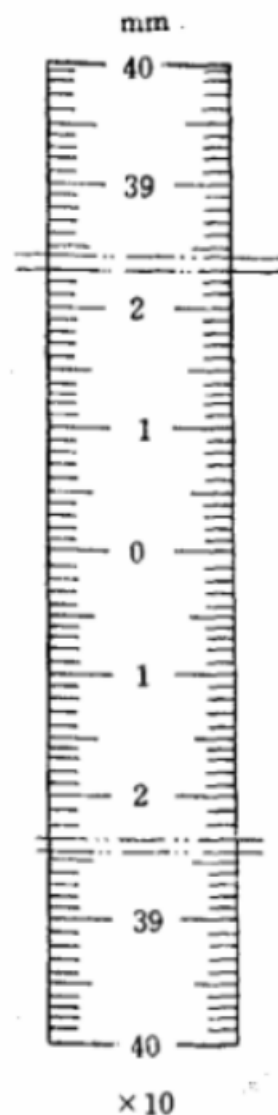
图 E3 U 型压力计标度
