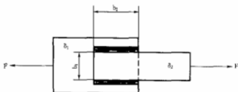
图 3-1 两侧面角焊缝连接尺寸示意图
