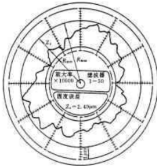
图 7 以最小区域圆圆心评定圆度误差 \Delta Z_0
