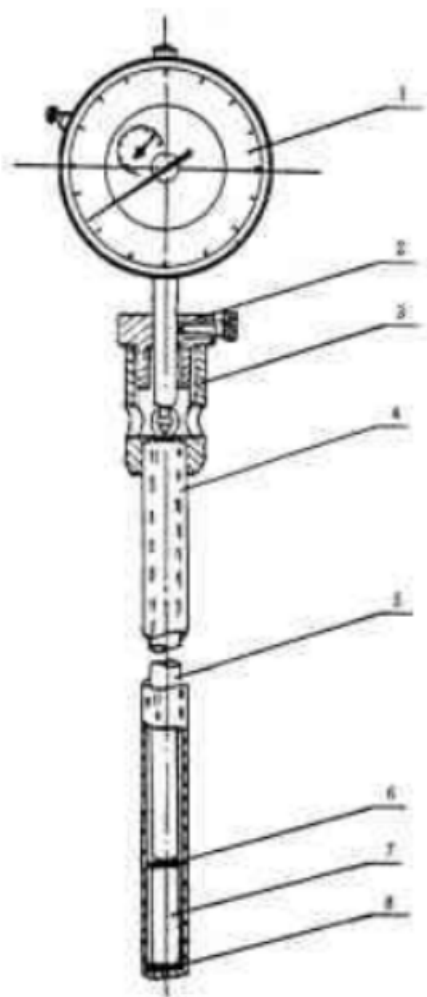
1—千分表； 2—表座； 3—连接件； 4—石英外管； 5—石英内管； 6、8—定位垫片； 7—试样
