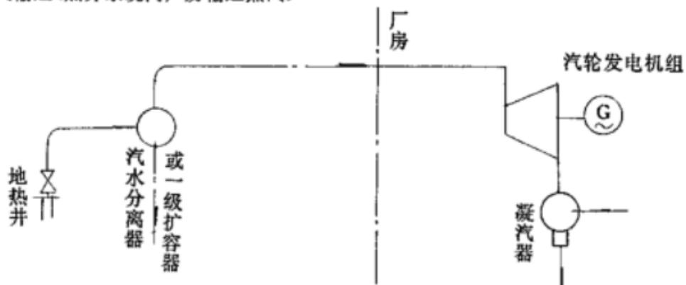
**E1.2 热水或汽水两相混合输送(热井系统向厂房输送热水或汽水混合物)**
