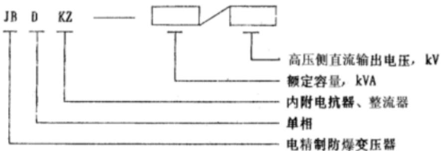
电精制变压器产品型号举例如下：
