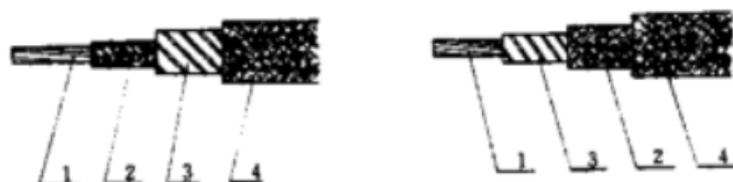
图1 JZ型电线结构示意图
