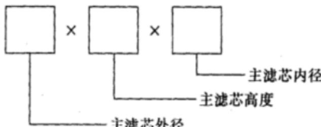
主滤芯外径、高度、内径均用阿拉伯数字表示, mm。
