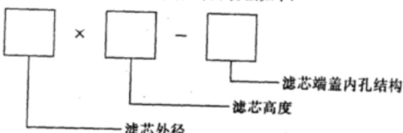
滤芯外径和高度均用阿拉伯数字表示，mm。
