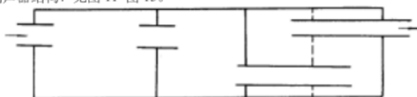
图11 C-1 内插管—穿孔板式回流四腔结构
