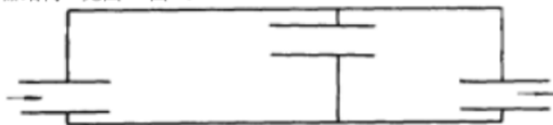
图 1 A-1 内插管式两腔结构
