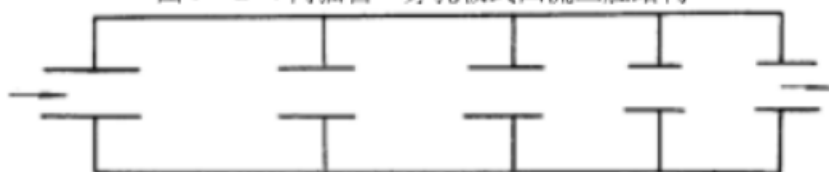
图10 B-5 内插管式四腔结构
