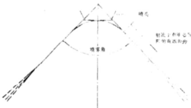
图6 测定喷雾角的原理图
