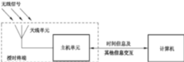
图 9 定位精度测试连接框图
