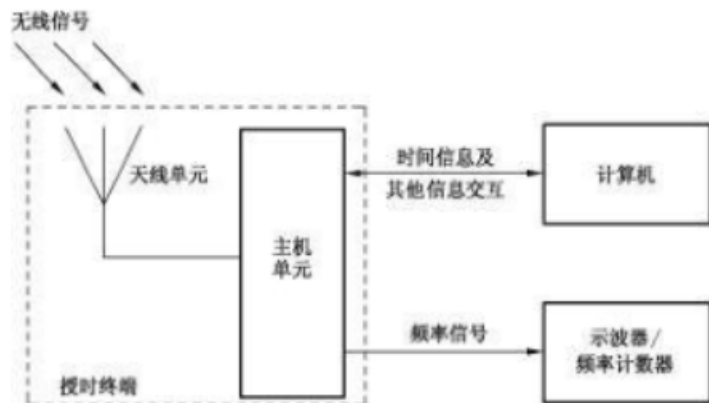
图 5 频率信号输出测试原理框图
