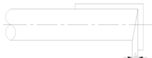
图 5.2.4 管子切口端面倾斜偏差
