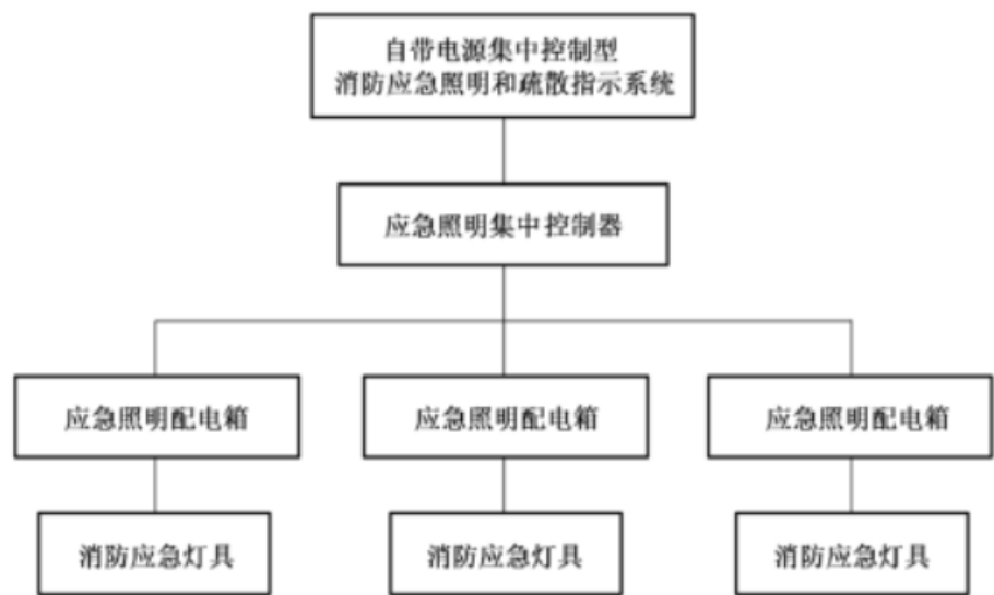
图 A.3 自带电源集中控制型消防应急照明和疏散指示系统组成
