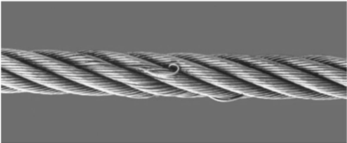
图 B.14 钢丝突出
