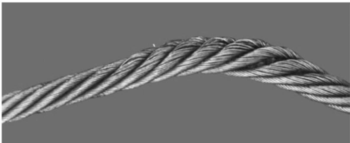
图 B.16 局部扁平(弯曲型)
