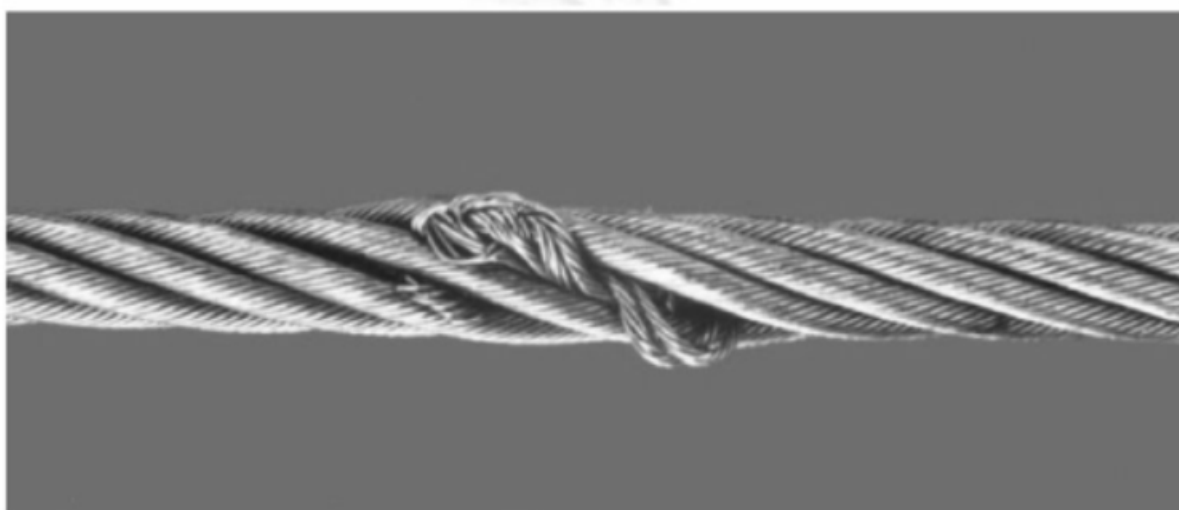
图 B.11 绳芯突出——单层钢丝绳
