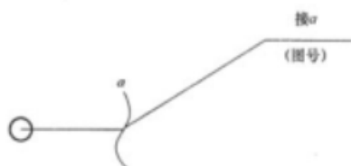
图 4.6.8 管道在本图中断的画法
