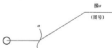
图 4.6.7 管道断开的画法
