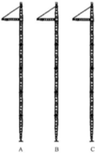
图 A.1 I 型:拉门杆塔 图 A.2 II 型:单柱上字型杆塔 图 A.3 III-1 型:单柱分相独立型杆塔
