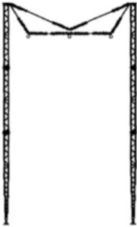
图 A.4 III-2 型:混合单柱分相独立型杆塔 图 A.5 IV 型:柔索型杆塔
