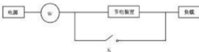
图 1 节电率测试示意图
