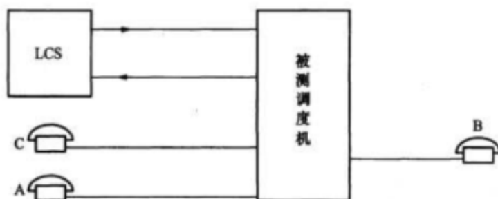
图 38 过负荷控制测试连接电路
