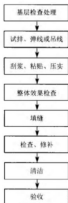
图 5.4.1 MCM 建筑饰面工程施工工序
