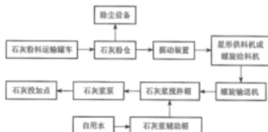
图 4.2.2 石灰粉料投加系统流程
