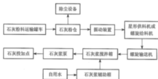
图 4.2.2 石灰粉料投加系统流程
