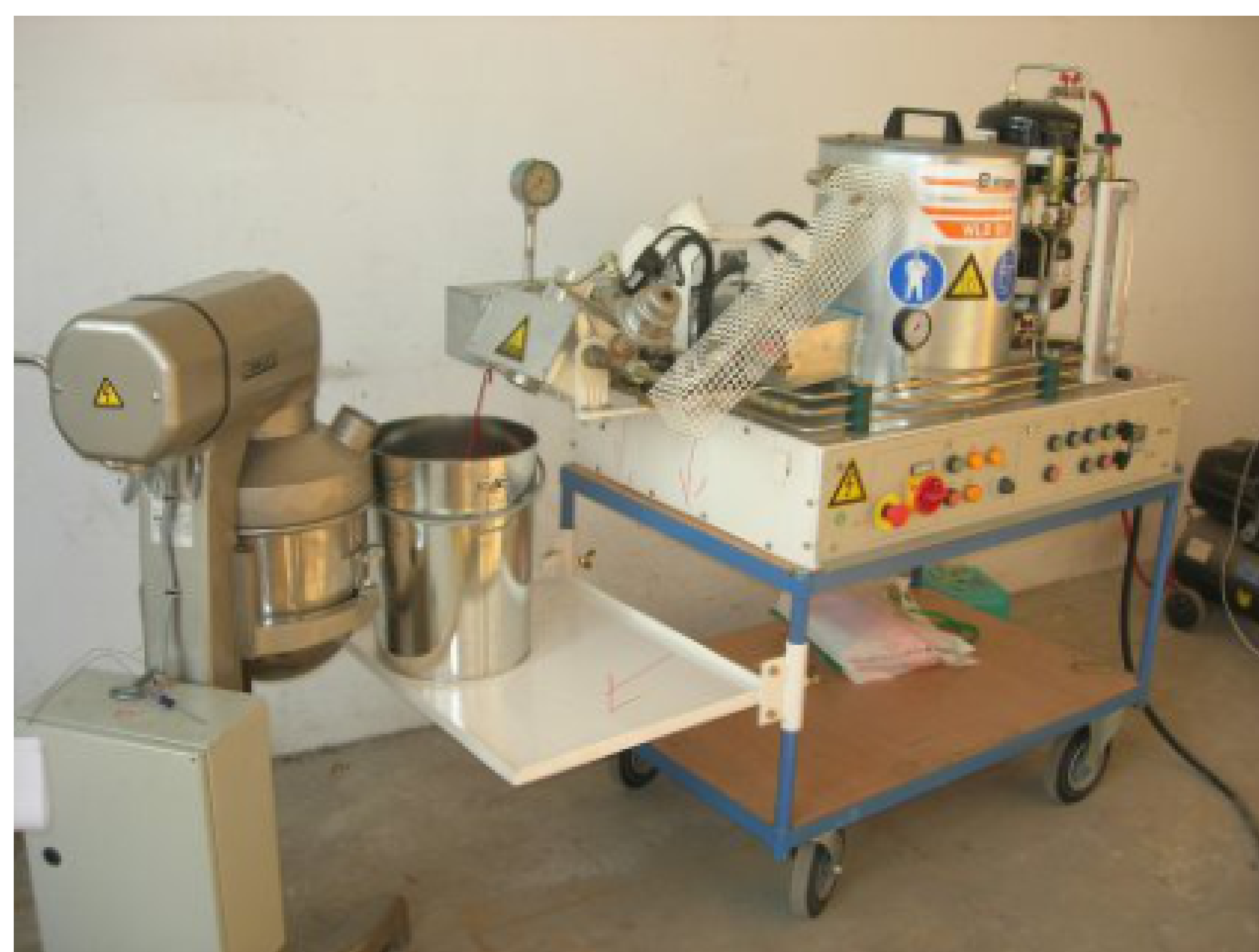
图 A.2.1-1 WLB10 实验室用沥青发泡设备图
