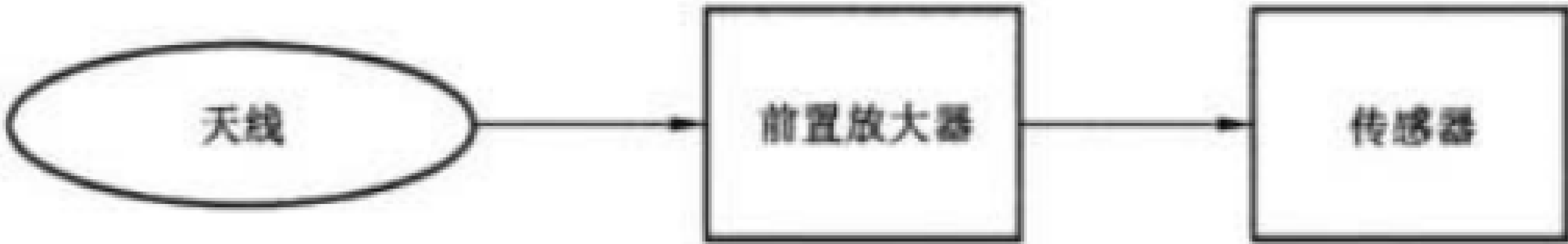
图 1 BDSBAS 机载设备组成示意图
