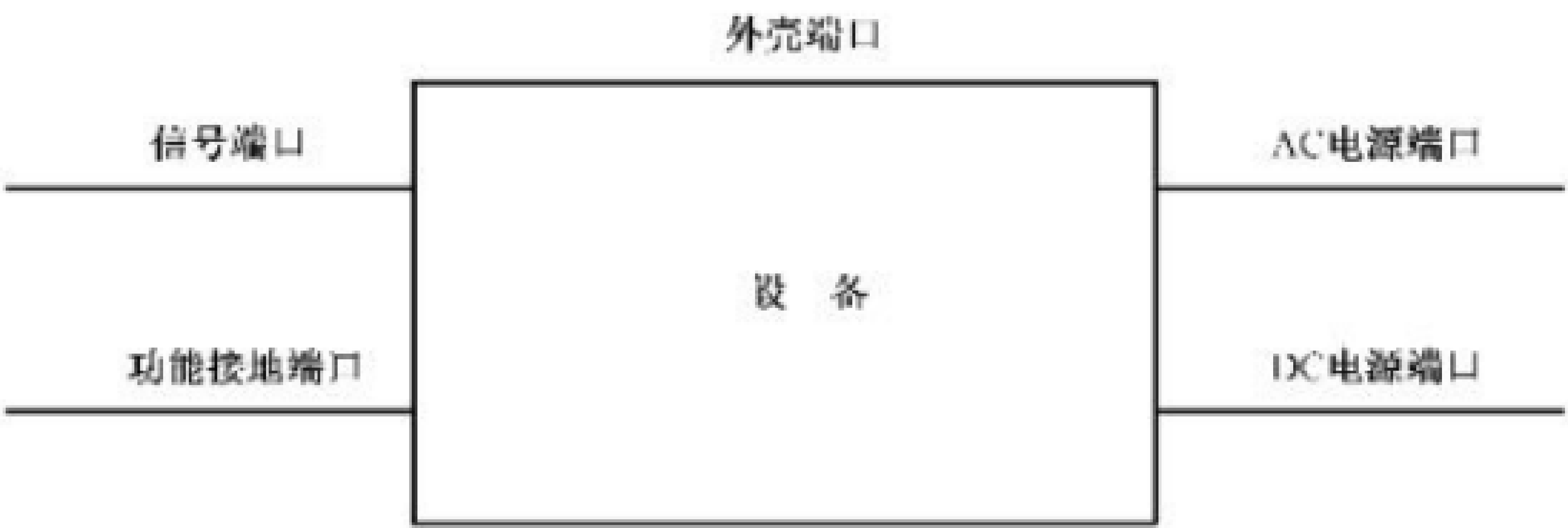
图 5 读写器抗扰度试验布置
