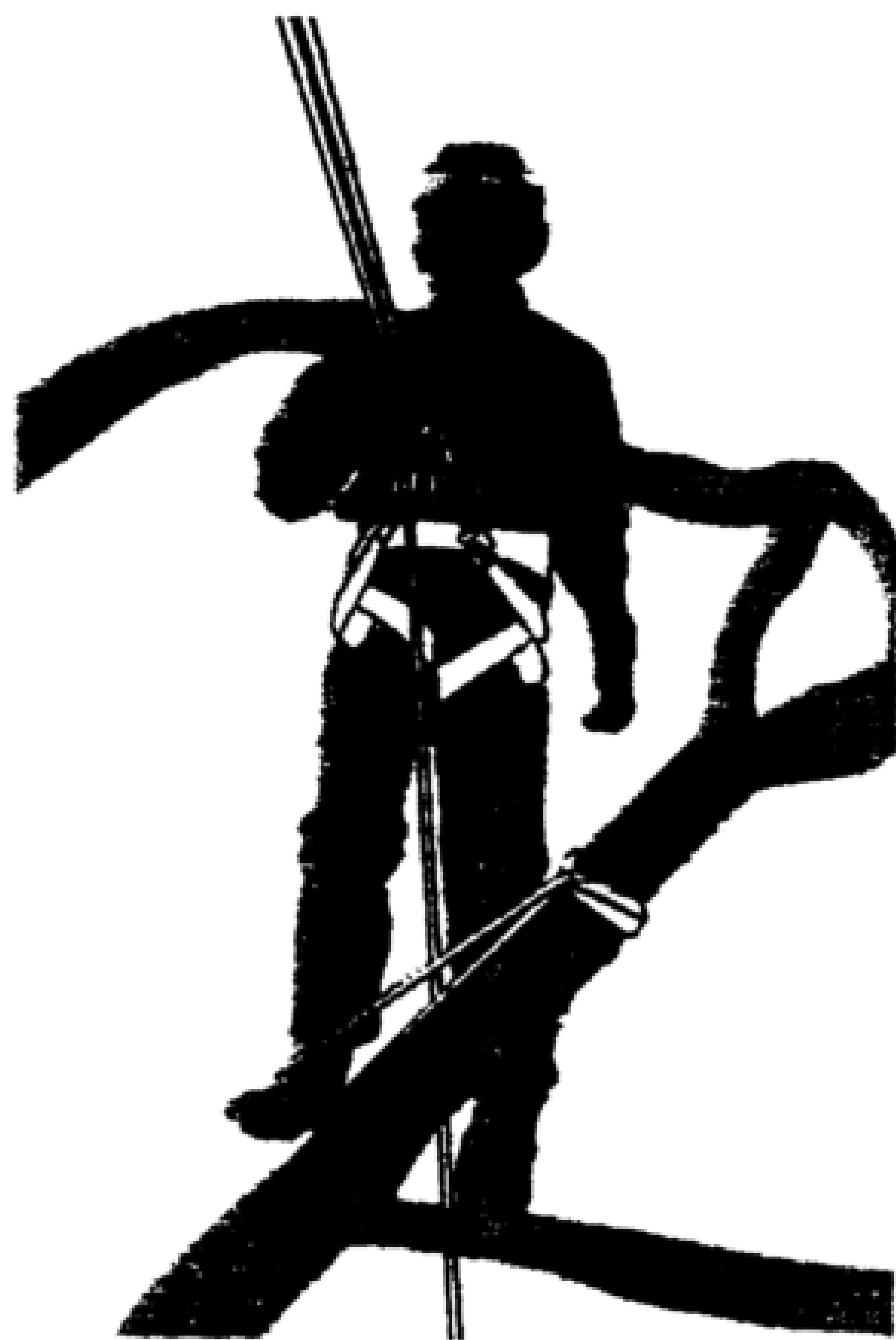
图 A.4 用环索做临时马镫的示例
