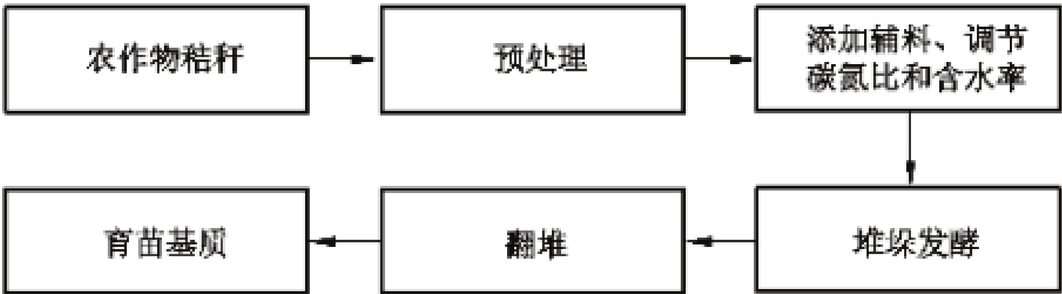
图 A.9 育苗基料制备工艺流程图
