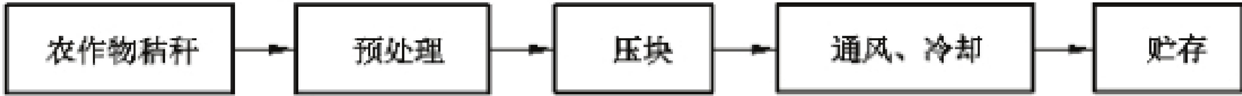
图 A.12 秸秆成型燃料工艺流程图
