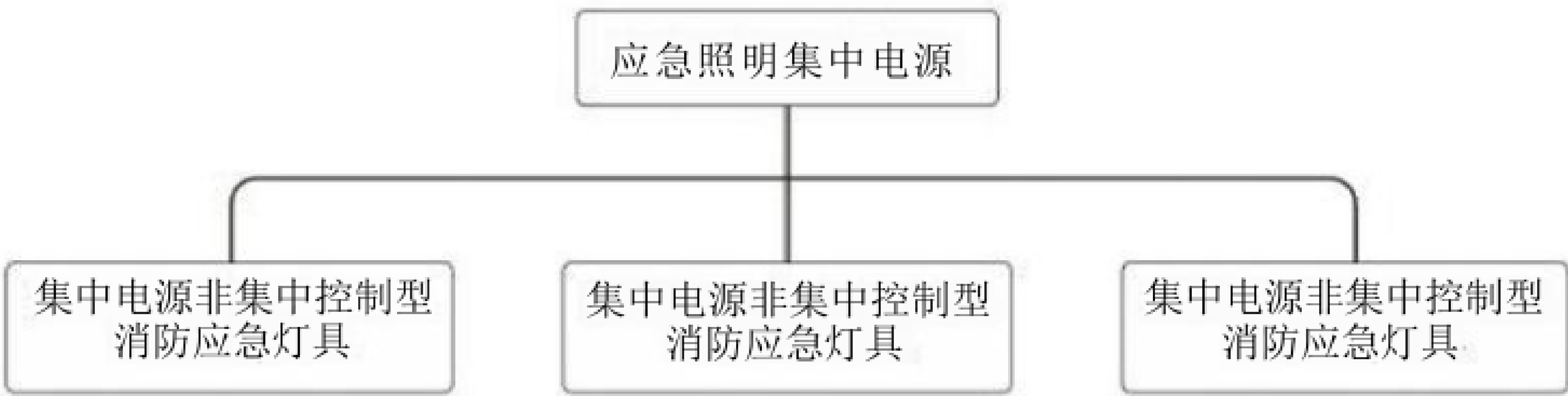
图A.3 集中电源非集中控制型系统组成示意图
