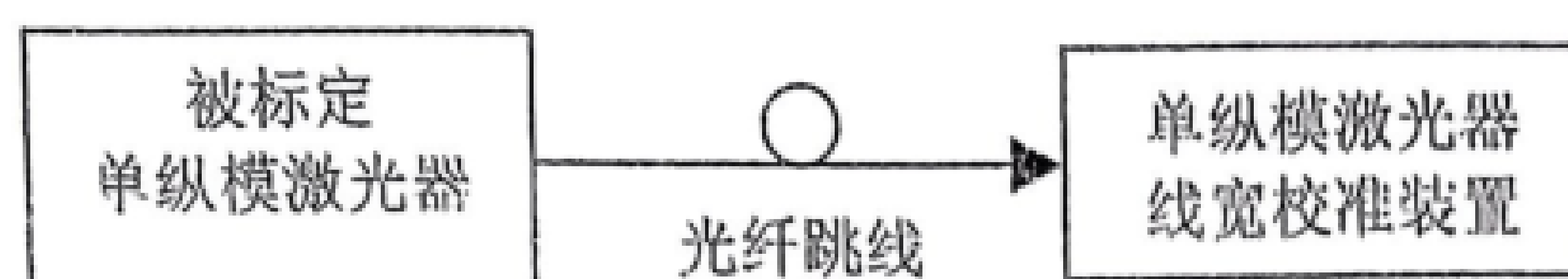
图 1 单纵模激光器线宽标定框图
