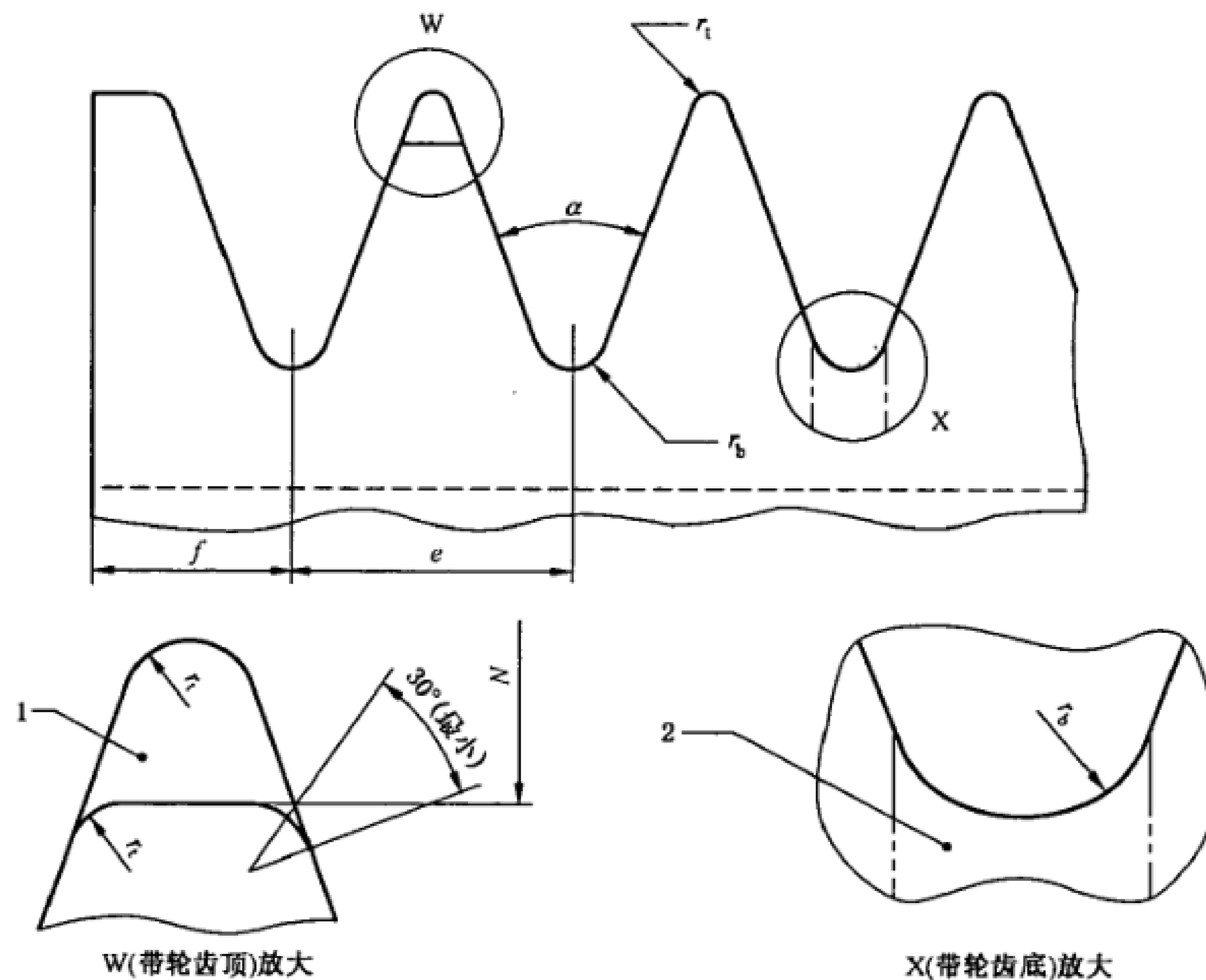
1——轮槽槽顶轮廓线可位于该区域的任何部位,该轮廓线的两端应有一个与轮槽侧面相切的圆角(最小 30°);
