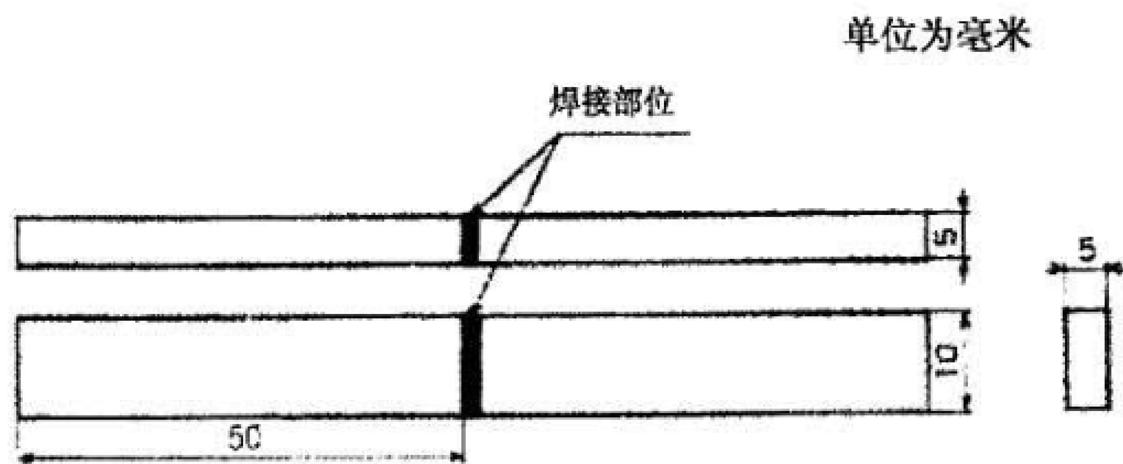
图6 拉伸试验焊接试样件示意图
