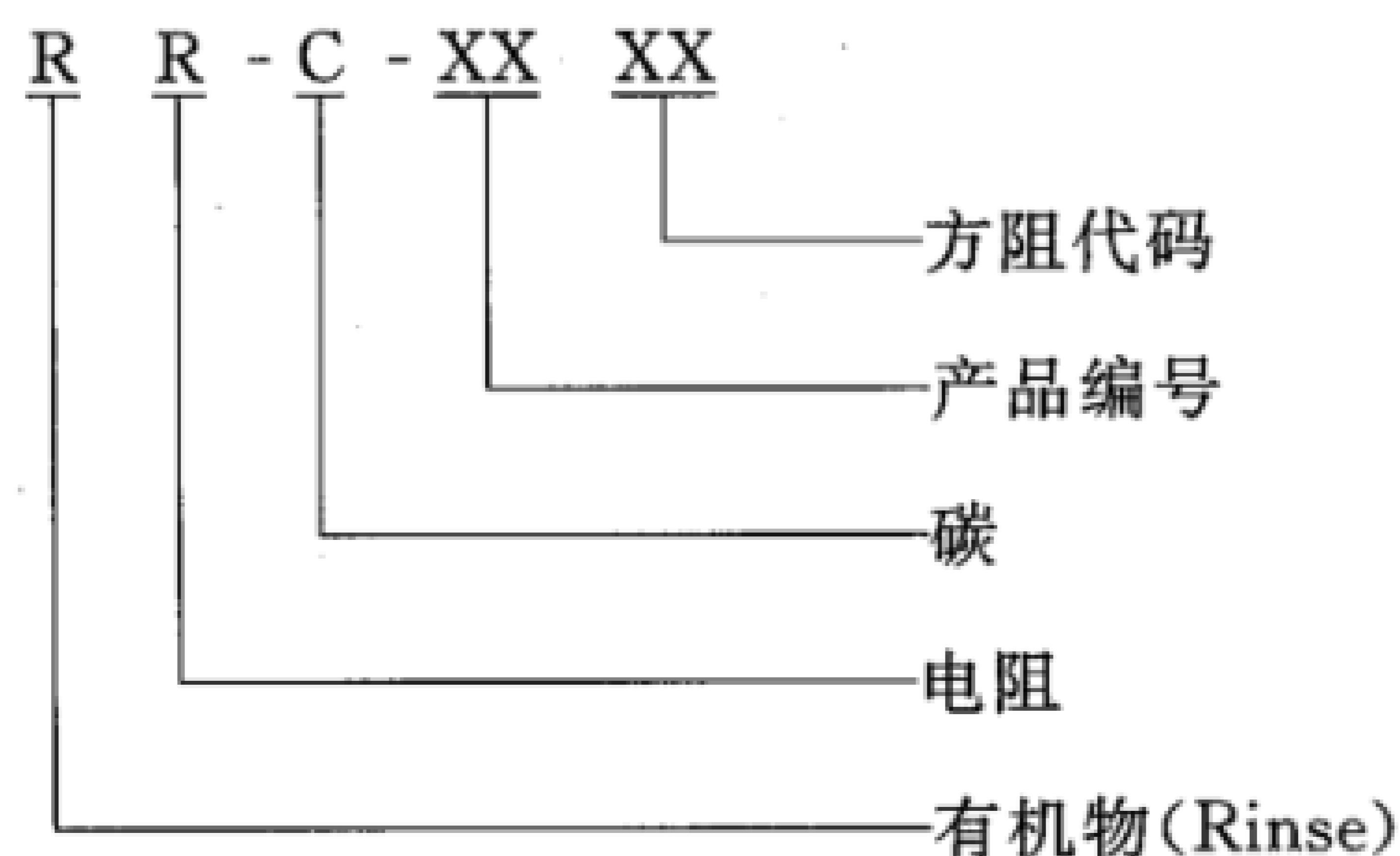
示例:RR-C-4822 表示方阻值为 200Ω/□的碳膜电位器用电阻浆料。
