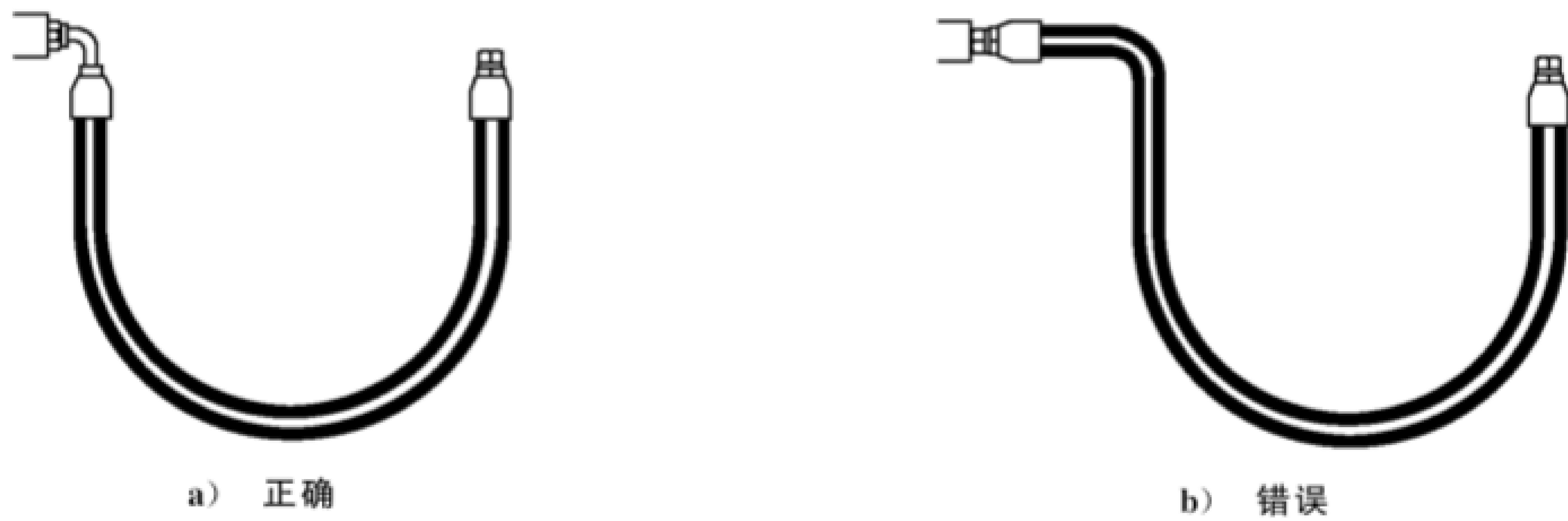
图 3 弯管接头与接头的过渡
