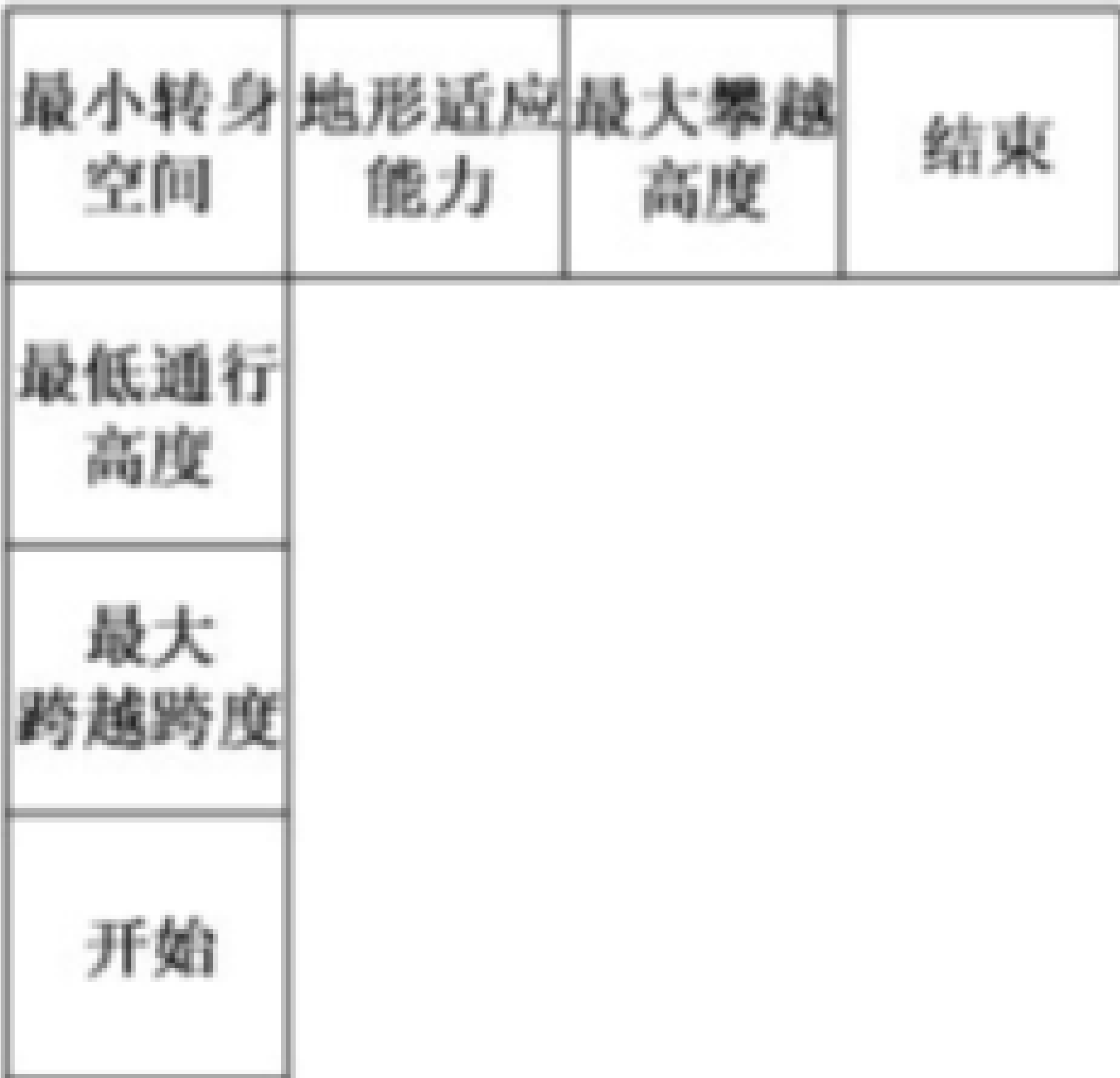
图 C.1 室外环境中作业的腿式机器人推荐使用的综合测试场的组成
