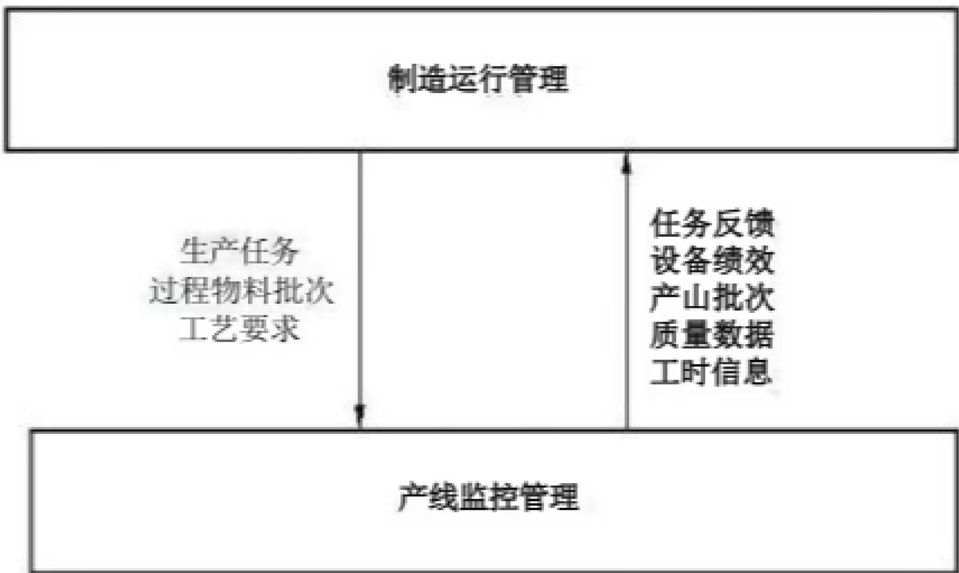
图7 制造运行管理与产线监控管理集成数据流图
