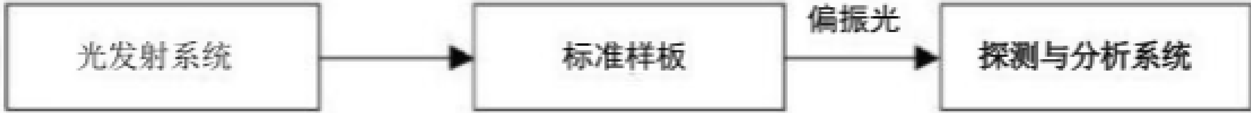
图 5 偏振法测试原理图
