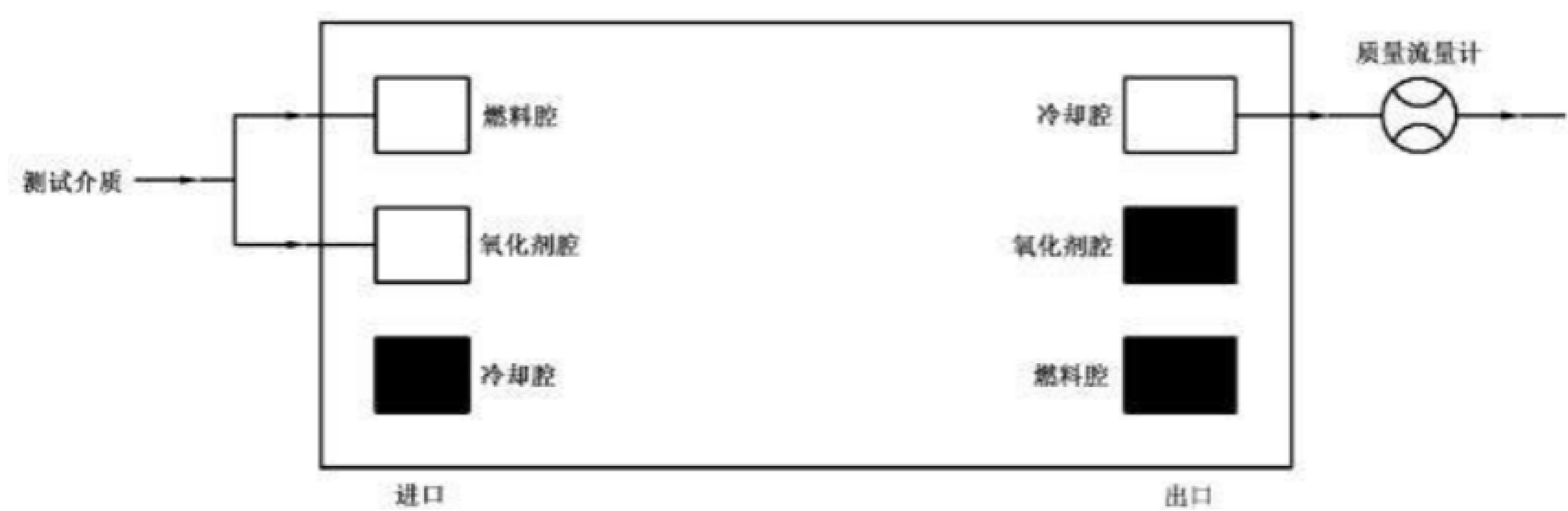
图 7 燃料腔、氧化剂腔到冷却腔窜漏测试示意图
