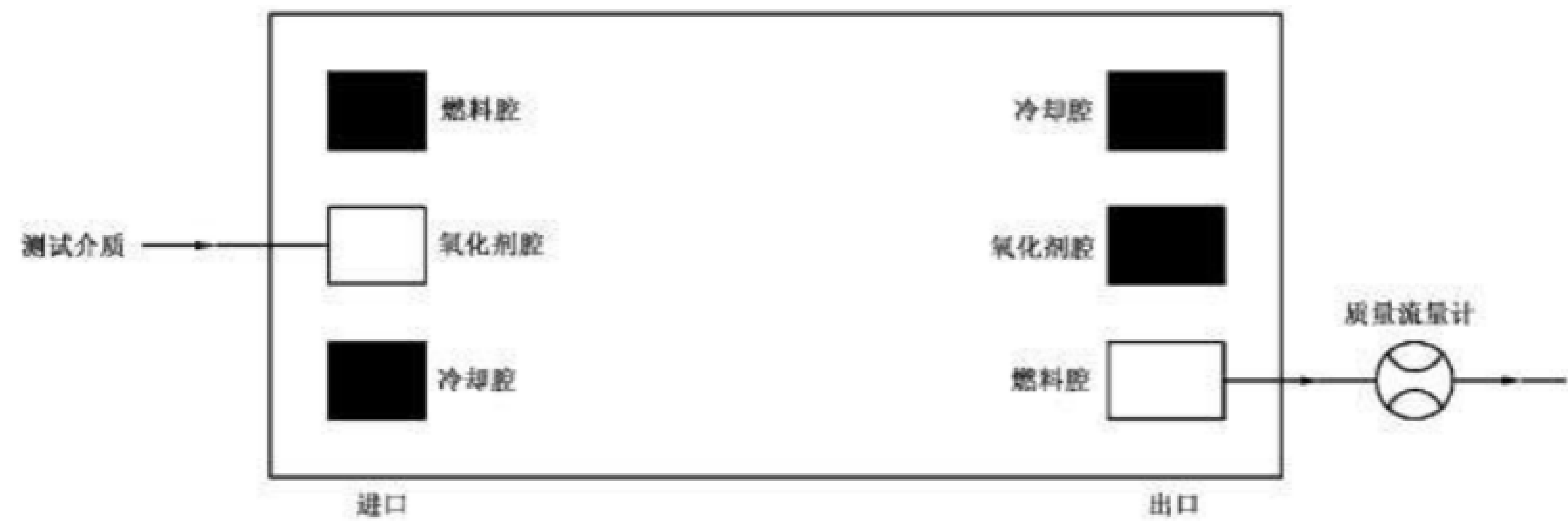
图 8 氧化剂腔到燃料腔窜漏测试示意图
