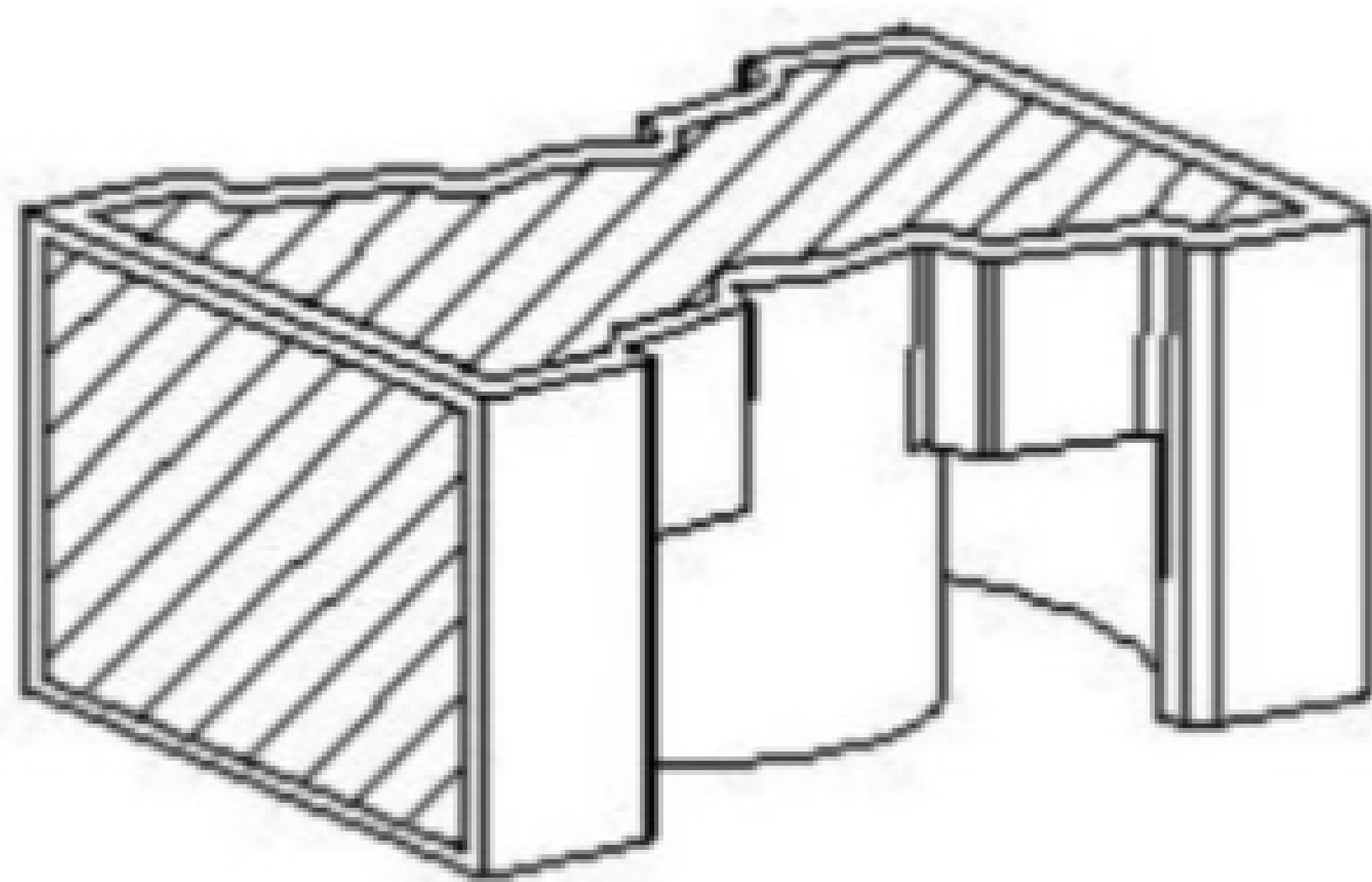
图 6 PQ 型磁心标记位置示例
