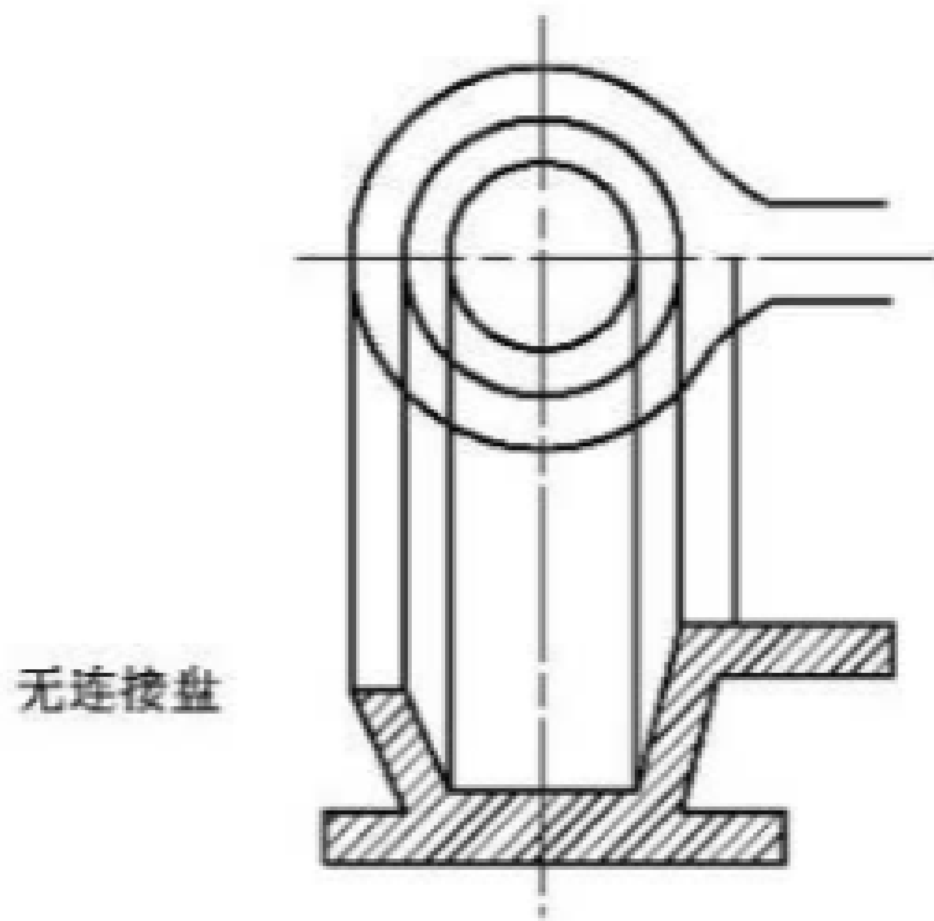
图 8 无连接盘微导通孔
