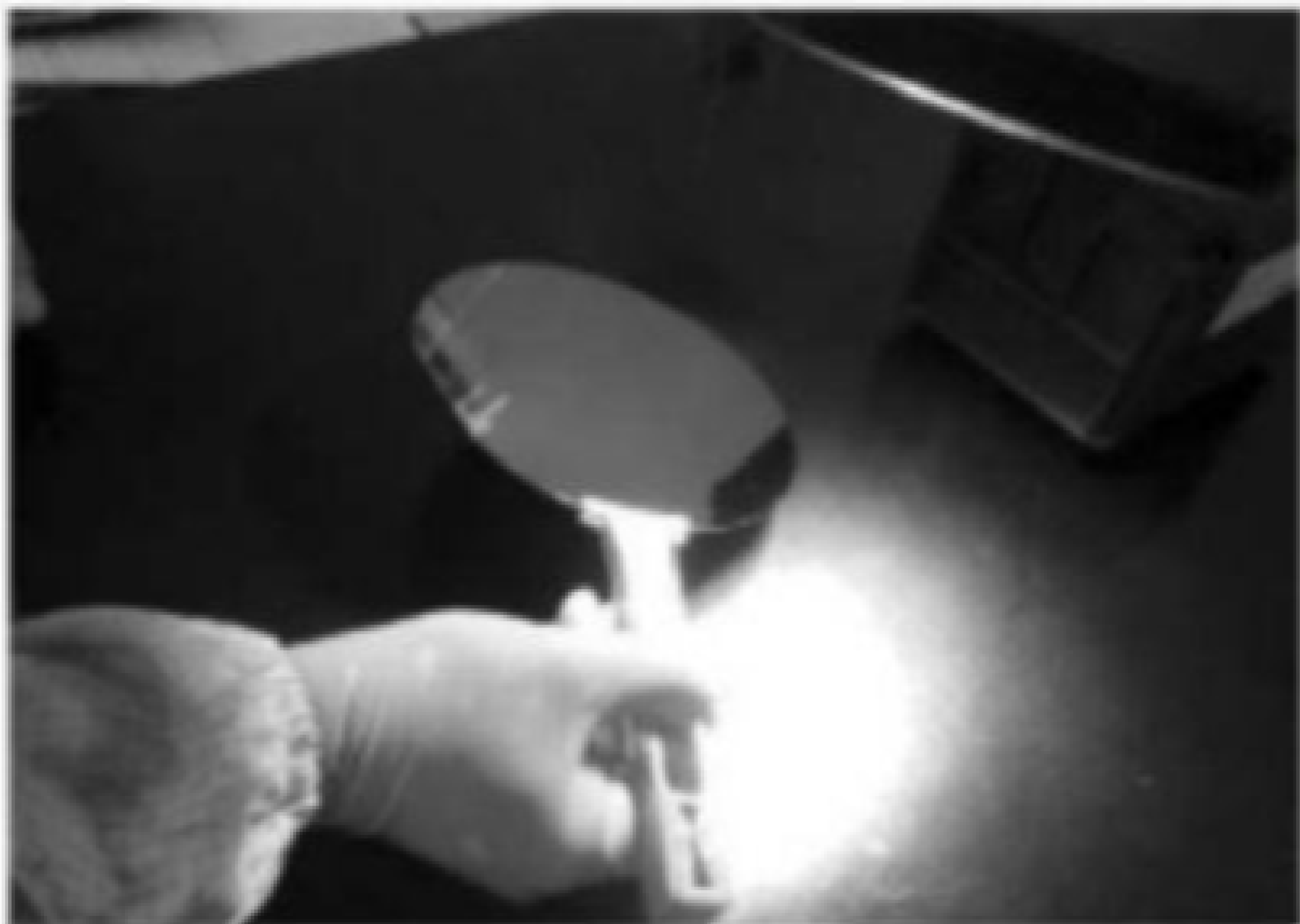
图 1 桌面型观察灯观察胶膜云纹
