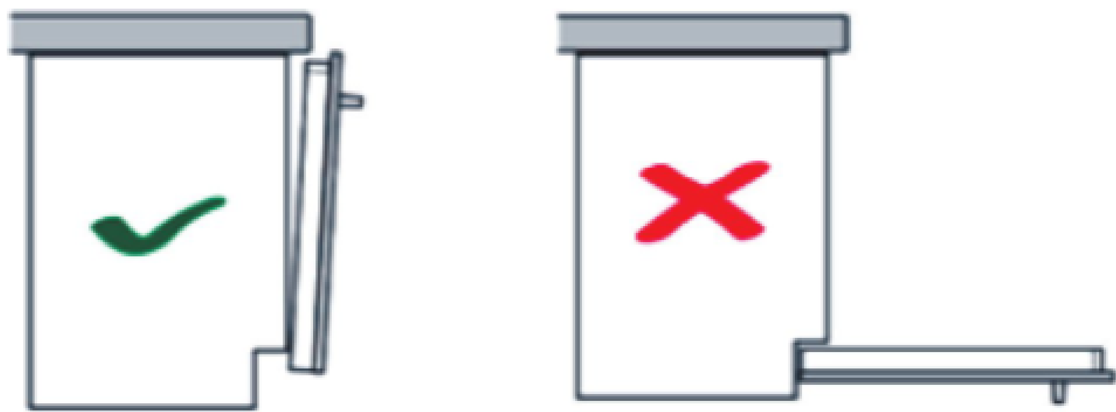
图 K.3 门打开并解锁(左图)要求的门位置
