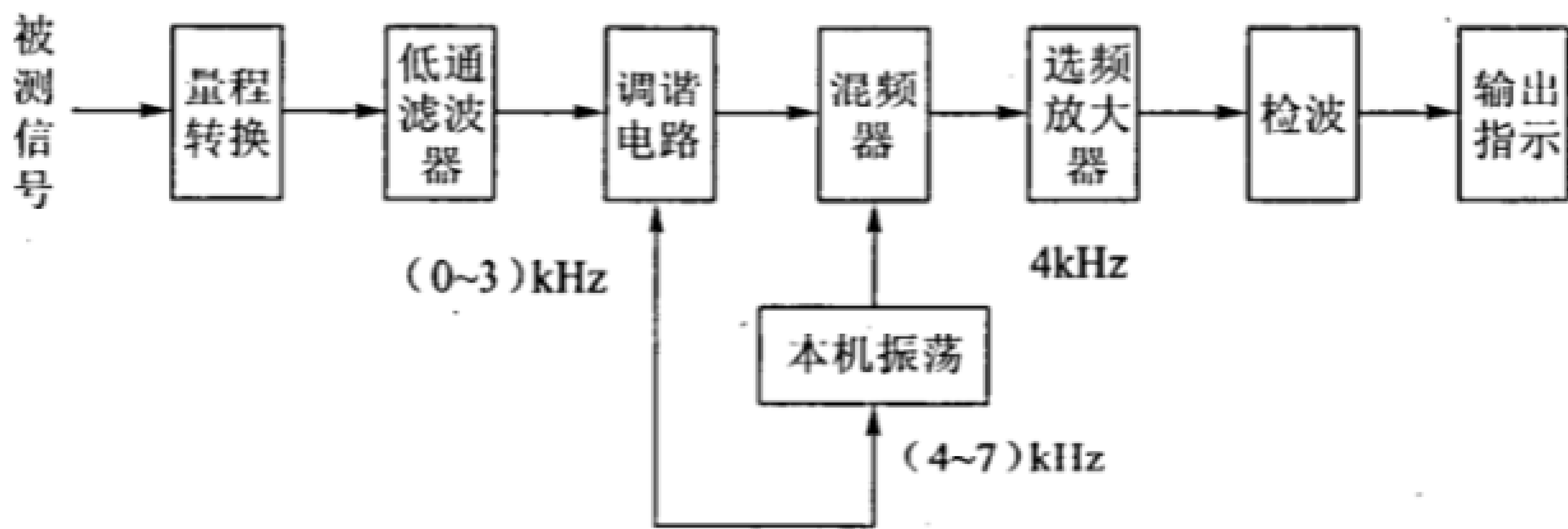
图 1 谐波和闪烁分析仪原理框图
